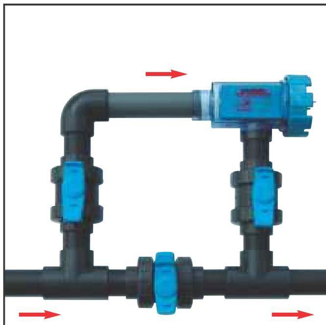
Pro instalaci cely do potrubního systému je možno použít jak vertikální tak horizontální polohu pouzdra cely. Vždy dbejte na dostatek místa pro vyjmutí cely z pouzdra. Instalace obtoku cely umožní jednodušší údržbu.
