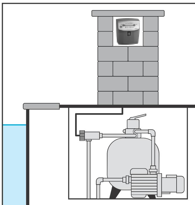
Možné řešení pro umístění ovládacího modulu v případech velké vlhkosti v technologické jímce.
