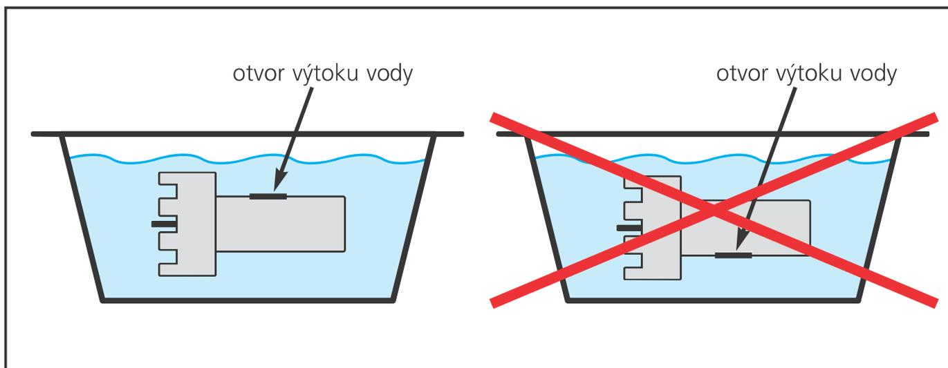
Postup při čištění cely: Vypněte zařízení, uzavřete průtok vody celou, odpojte napájecí kabel cely a vyndejte celu z pouzdra. Znečištěná cela se ponoří do nádržky, která obsahuje čistící roztok = 8 dílů vody + 1 díl kyseliny solné HCl (30–33 %).
