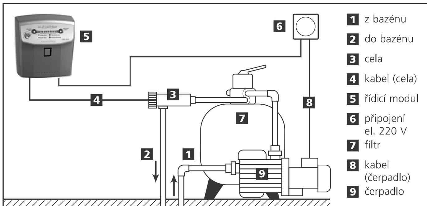
Umístění a poloha cely v potrubním systému musí umožnit zbytku vody z cely odtéci v případě akumulace plynu v cele. Připevněte ovládací modul přístroje na zeď nebo jinou vertikální podporu ve vzdálenosti dané délkou napájecího kabelu elektrolytické cely. Místo pro upevnění ovládacího modulu přístroje musí být dobře odvětrané a umožnit dobrou cirkulaci vzduchu kolem ovládacího modulu. Ovládací modul musí být umístěn na suchém místě a chráněn před vniknutím vody.
