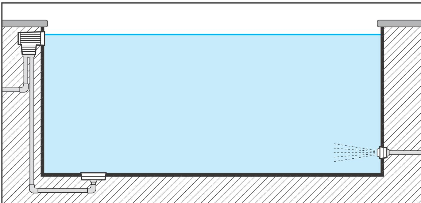
Nelze-li z konstrukčních důvodů umístit trysky co nejnižší, je nutné zabezpečit jejich směřování tak, aby proudící voda směřovala co možná nejvíce do hlubší části bazénu. Tento požadavek je dán nutností stejnoměrné distribuce sanitčních činidel.
